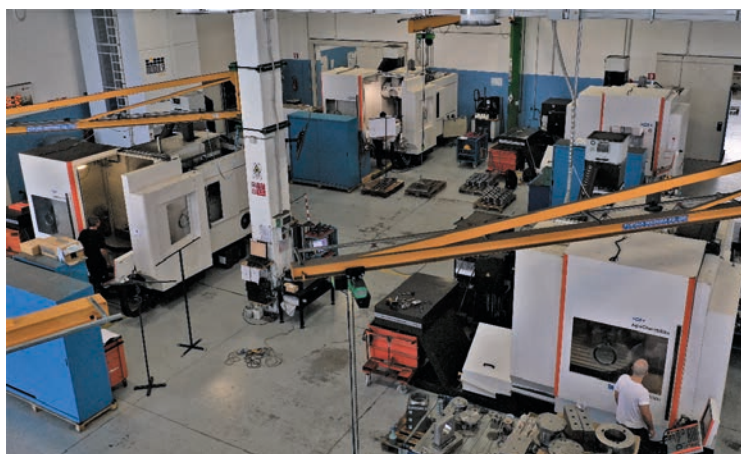
Reparto di lavorazione con le macchine utensili a 3, 4 e 5 assi
