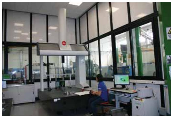
*Il reparto di controllo qualità, dove sono installate tre macchine di misura a coordinate*
