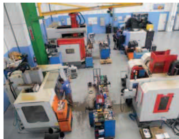
Del parco macchine fanno parte, tra gli altri, 12 centri di lavoro, 5 torni a controllo numerico, 1 macchina per l'elettroerosione a tuffo e 1 a filo di GF Machining Solutions
